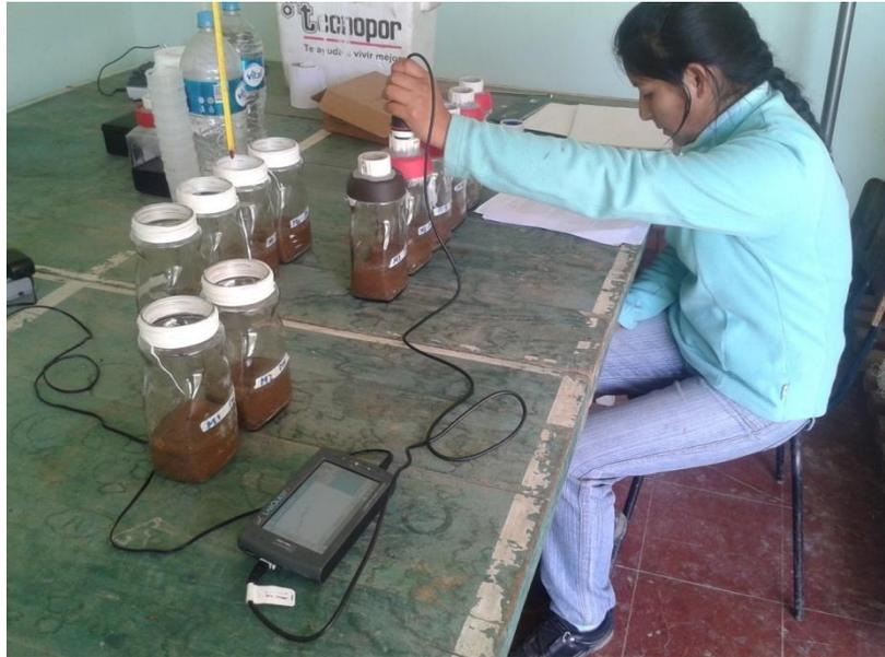
Vernier LabQuest 2 cuyo sensor de gas permite medir los niveles de  $\text{CO}_2$  controlando la cantidad de radiación infrarroja absorbida por las moléculas de este gas.
